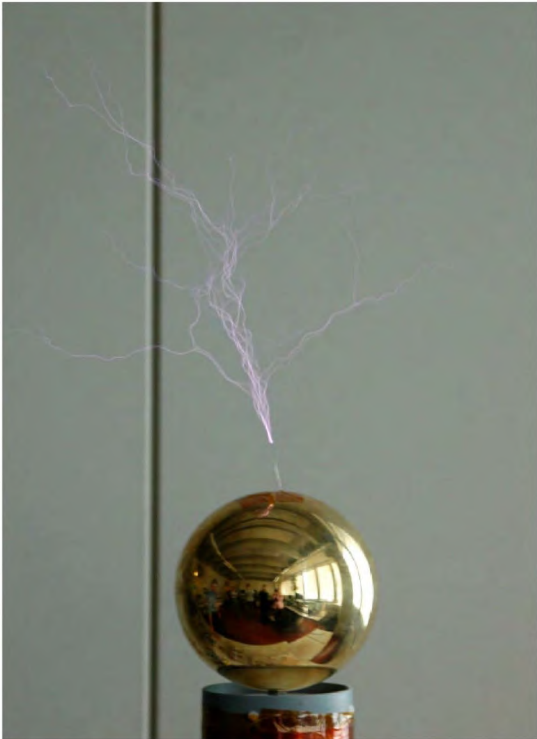
Mit kurzer Belichtungszeit aufgenommene Streamer. Die verästelte Struktur ist gut zu erkennen.
