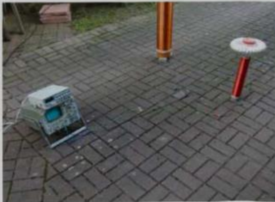
الشكل 12: تحديد تردد الرنين للملف الثاني على الكائن الحي باستخدام مولد الموجة الجيبية ورسم الذبذبات
