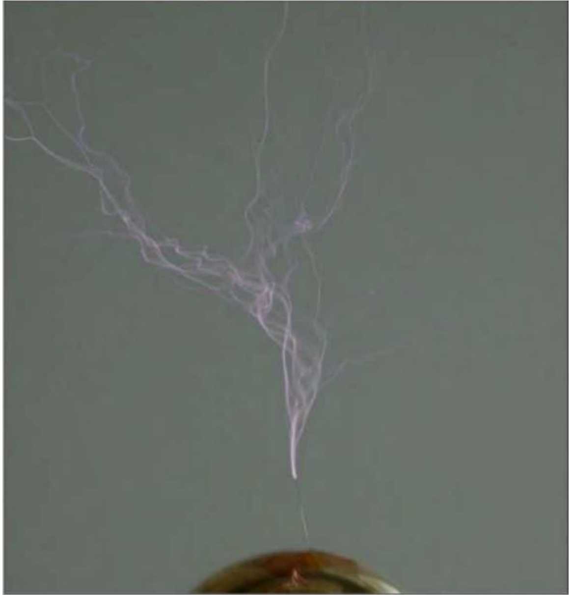
عرض مفصل للانفجارات. يمكن رؤية انقباض القنوات الرئيسية الواقعة بالقرب من نهاية السلوك بواسطة دوامات الهواء التي تحدث نتيجة للتسخين بوضوح.
