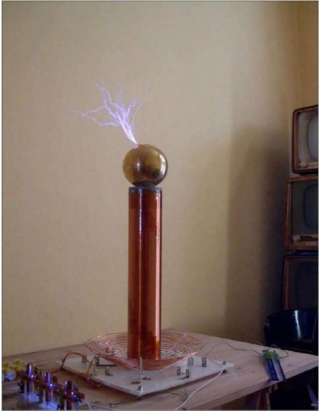
هذه الصورة ، التي تم التقاطها بوقت تعريض متوسط ، تقترب جدًا من الانطباع الفعلي. التصريفات داخل فجوة الشرارة واضحة للعيان أيضًا.
