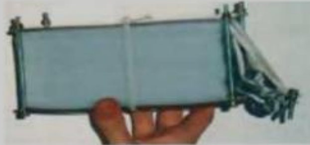
الشكل 4: الأعمال الداخلية للمكثف
