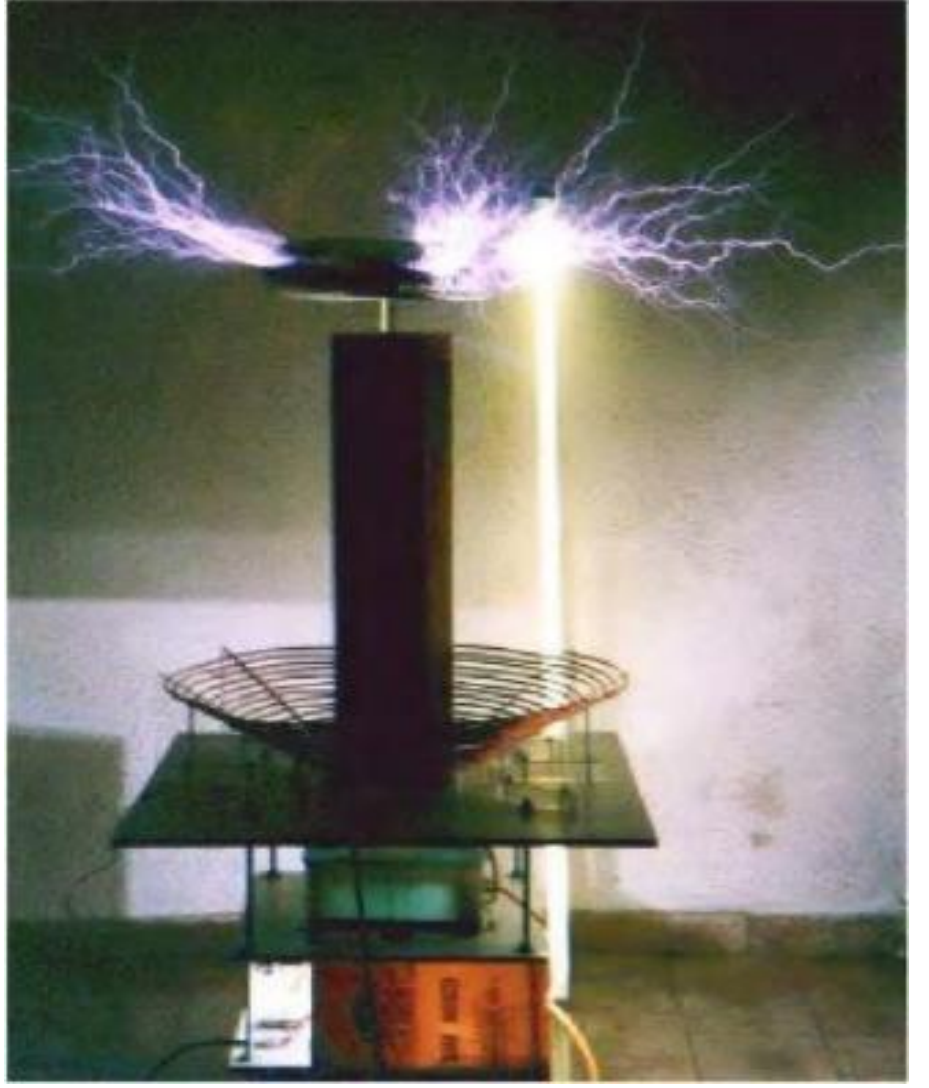
الشكل 9: الحقول الإلكترونية القوية تجعل أنبوب الفلورسنت يتوهج
