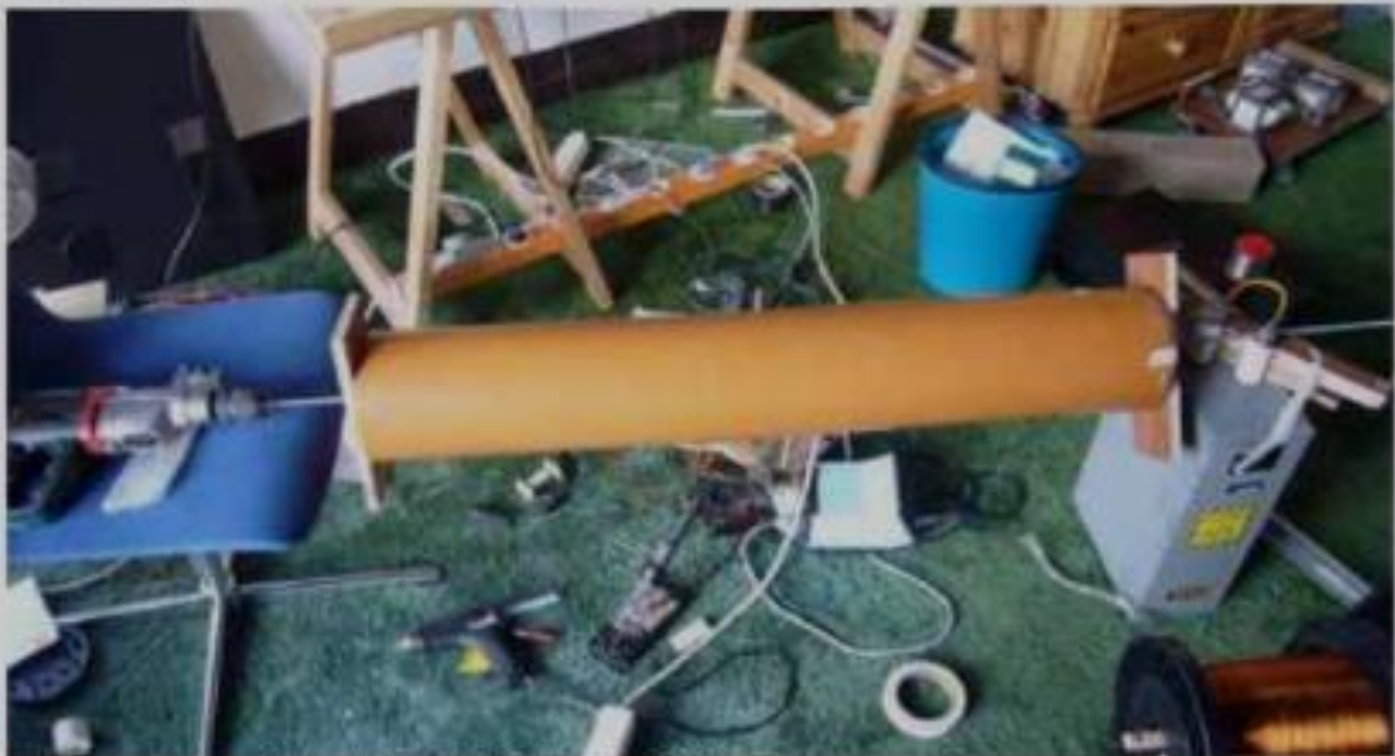
الشكل 10: آلة لف "داوية" للملفات الثانوية ، لكنها تعمل!
