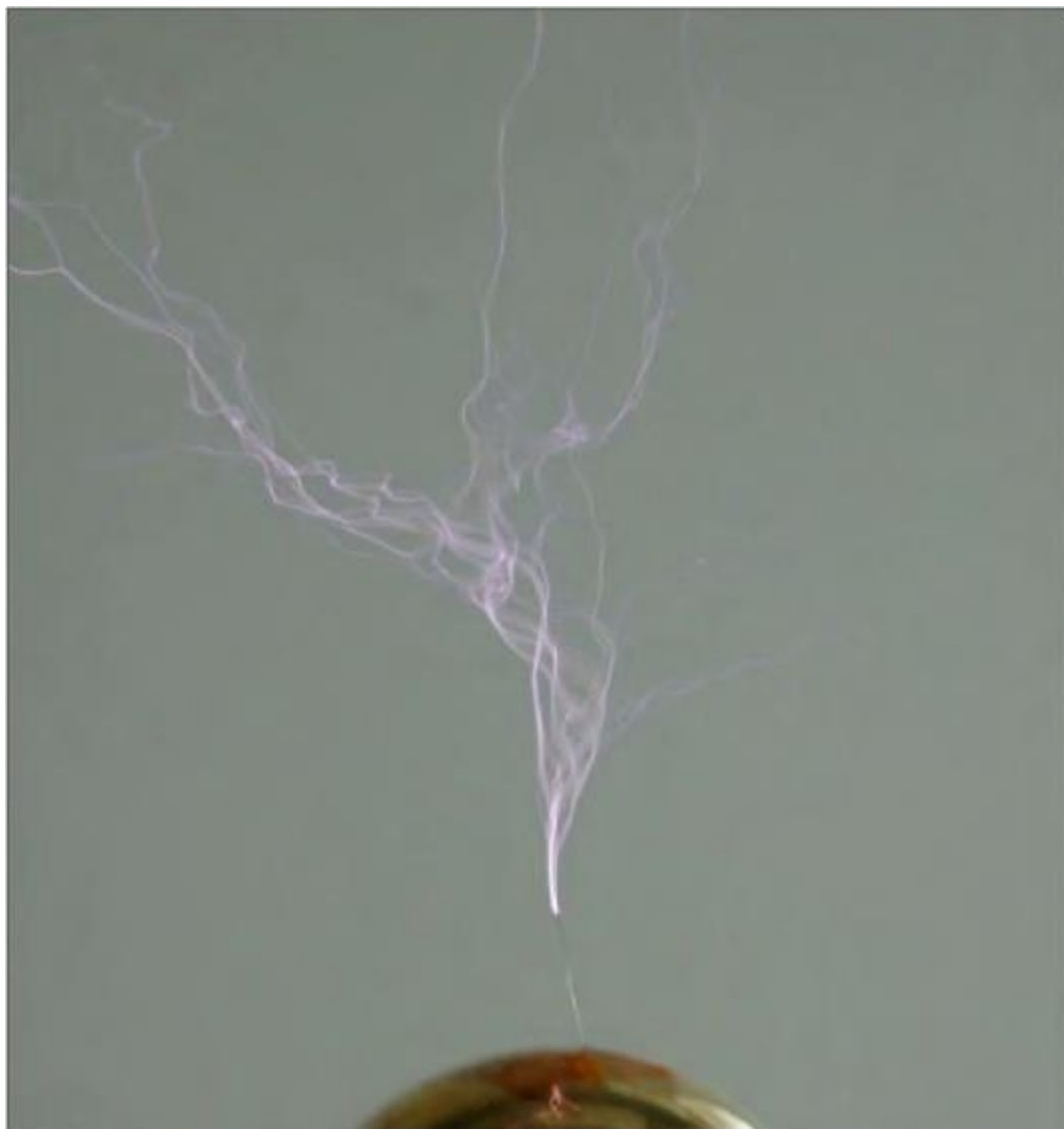
عرض مفصل للافتات . يمكن رؤية انحياز القنوات الرئيسية الواقعة بالقرب من نهاية السلك بواسطة دوامات الهواء التي تحدث نتيجة التسخين بوضوح
